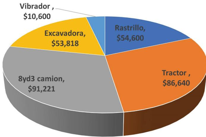
Figura 4. División del costo anual para operar maquinaria en una instalación de compostaje de *sargazo*.
